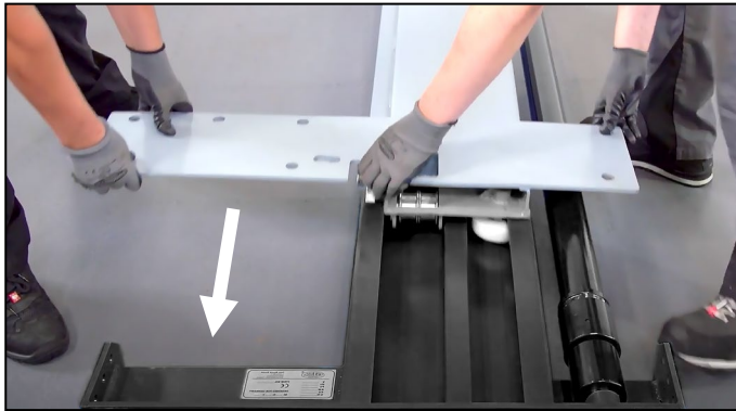
Abbildung: Nach Einsatz des Hydraulikzylinders
