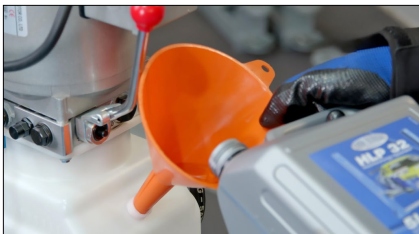
Abbildung: HLP 32 einfüllen
