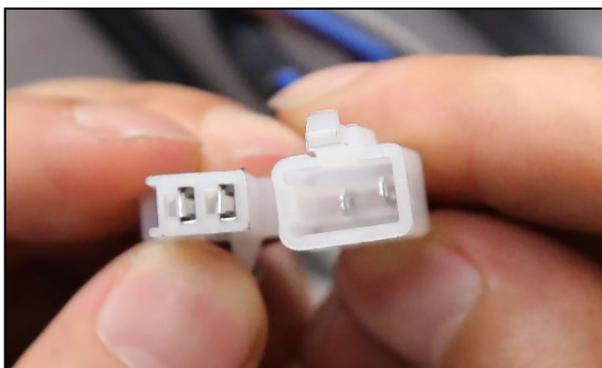
Abbildung: Pins im Inneren der Stecker
