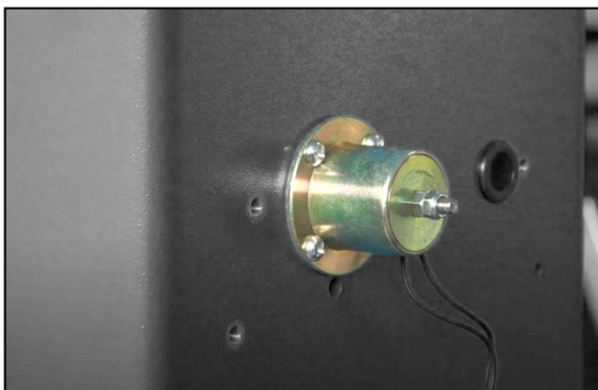
Abbildung: Elektromagnet an der Außenfläche der Säule
