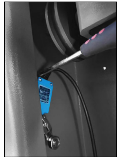
Abbildung: Position des Endabschalters
