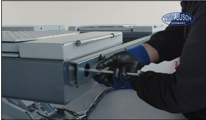
Abbildung: Montage Querbalken
