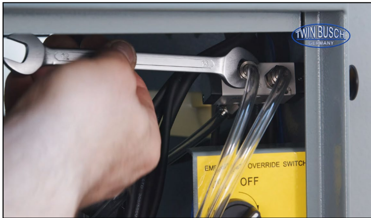
Abbildung: Anschließen der Schläuche zur Verriegelung der Schwingplatten
