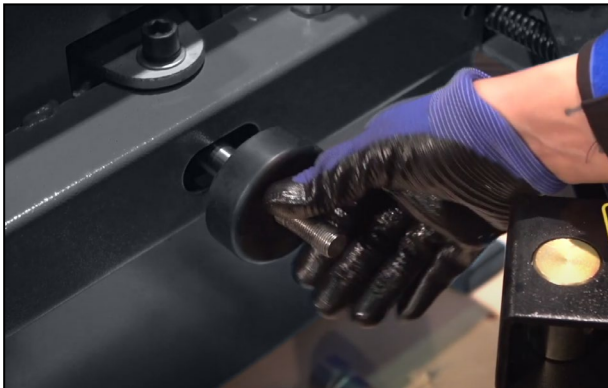
Abbildung: Befestigung Gummianschlag
