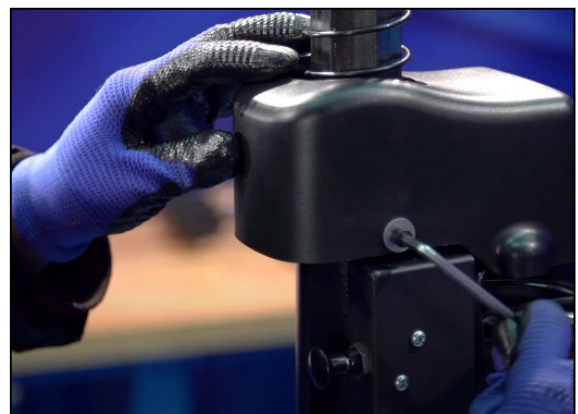
Abbildung: Einsetzen der Schutzkappe
