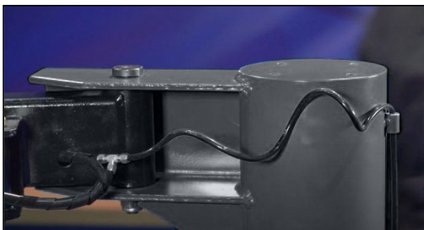
Abbildung: Druckluftschlauch an der Maschine
