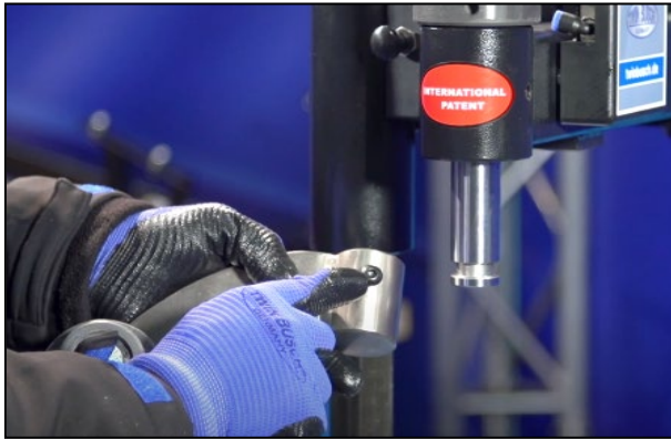
Abbildung: Verschrauben des Hilfsarm
