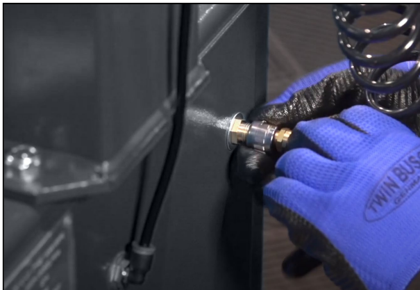
Abbildung: Verschraubung Druckluftausgang
