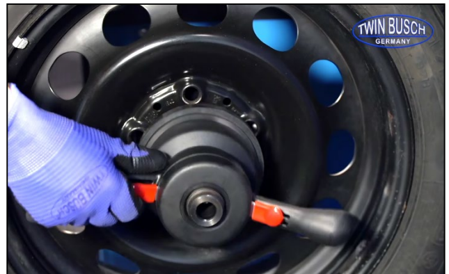
Abbildung: Lösen & Schließen der Schnellspannmutter
