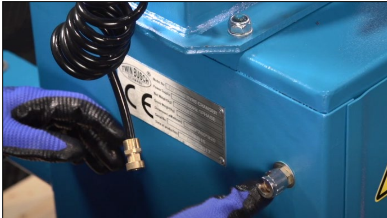
Abbildung: Verschraubung Druckluftausgang
