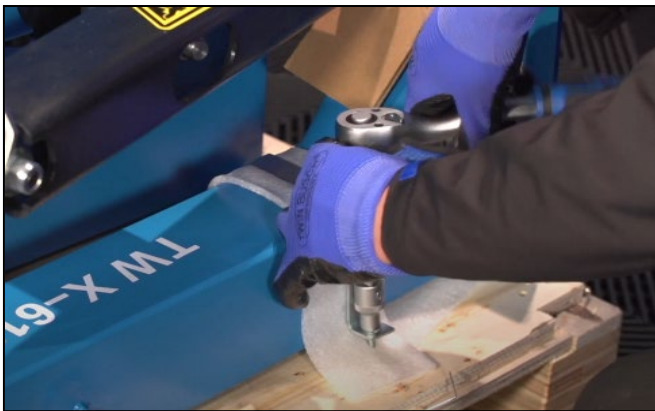
Abbildung: Entfernen der Transporthalterung
