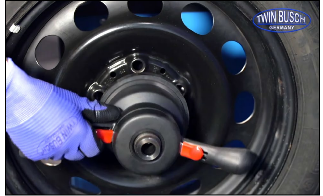
Abbildung: Lösen & Schließen der Schnellspannmutter
