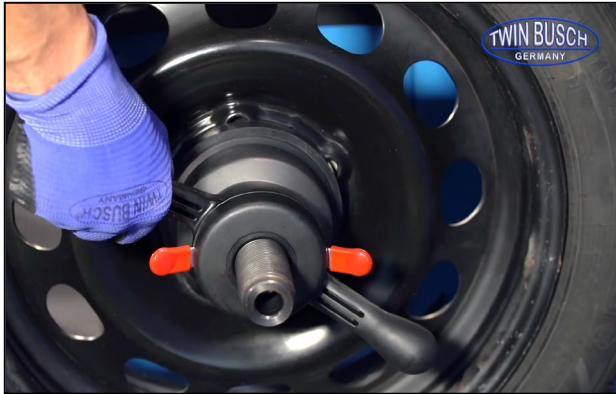
Abbildung: Drehen der Schnellspannmutter
