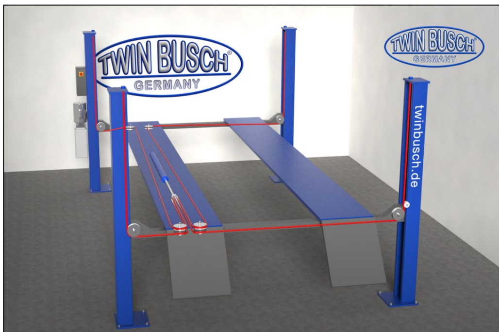
Abbildung: Verlegen der Stahlseile
