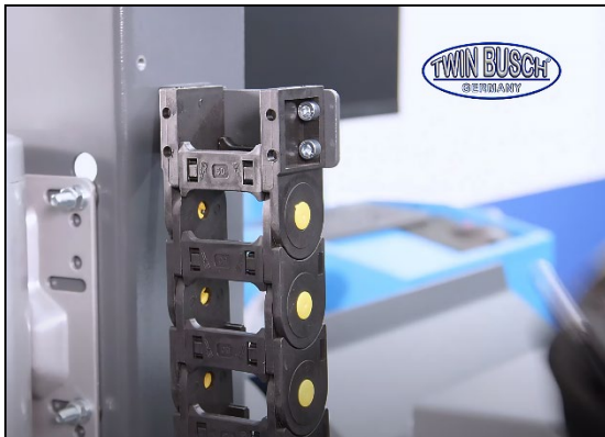
Abbildung: Befestigen der Schleppkette
