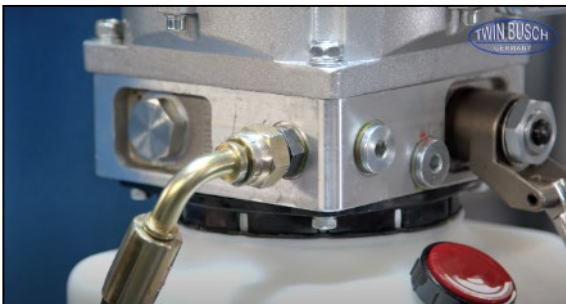
Abbildung: Anschließen des Hydraulikschlauchs
