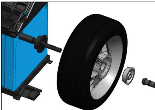
Abbildung: Negative Positionierung – Konus außen
