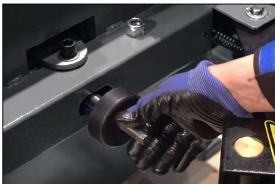
Abbildung: Befestigung Gummianschlag
