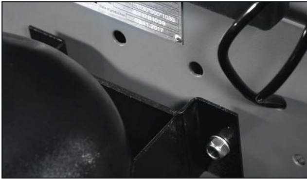
Abbildung: Einhängen des Tanks
