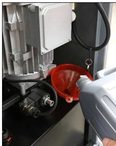
Abbildung: HLP 32 einfüllen
