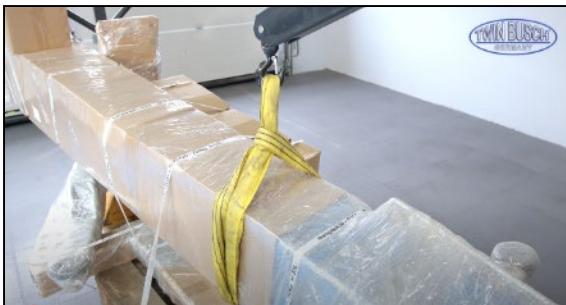
Abbildung: Verwendung eines Hebegurts
