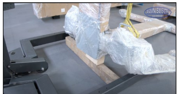
Abbildung: Unterlegung der Tragarm-Einheit
