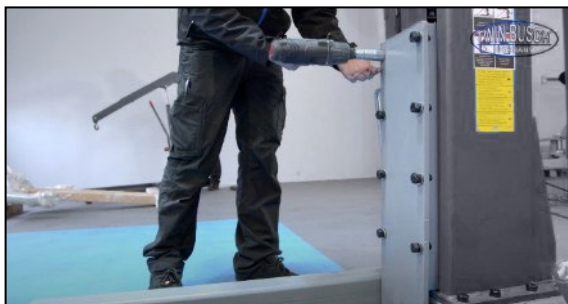
Abbildung: Befestigen der Schrauben
