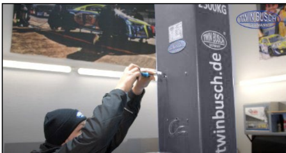
Abbildung: Anschließen des Motors
