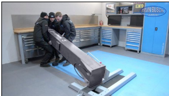
Abbildung: Aufrichten der Säule
