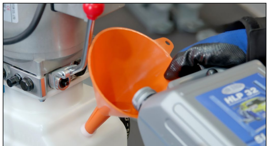
Abbildung: HLP 32 einfüllen
