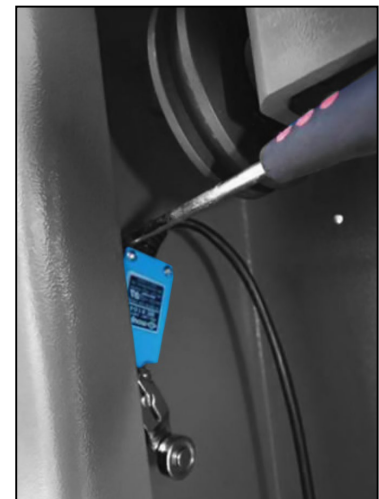
Abbildung: Position des Endabschalters
