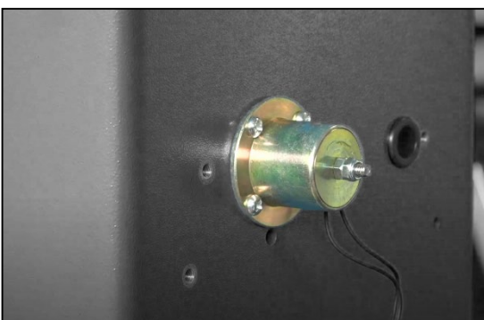
Abbildung: Elektromagnet an der Außenfläche der Säule
