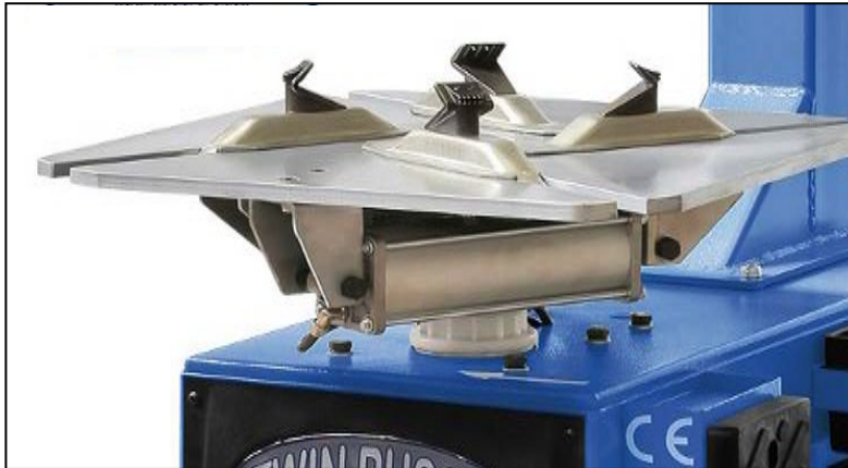
Abbildung: Felgenschoner auf Greifarme
